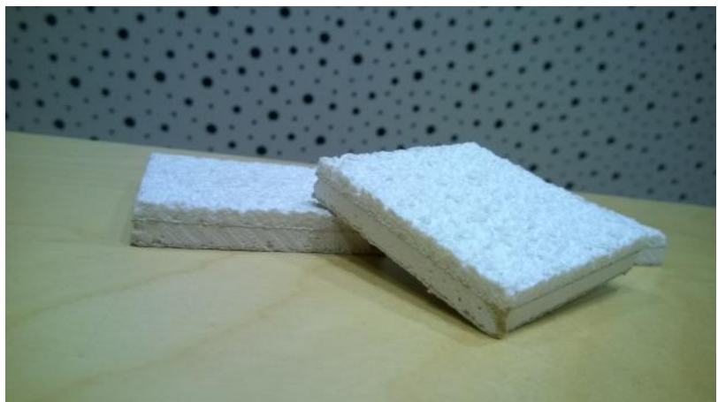
Kuva 3. Mallipalat Knauf Oy:n Lumir Board-levykaton pintakäsittelystä. [35]
