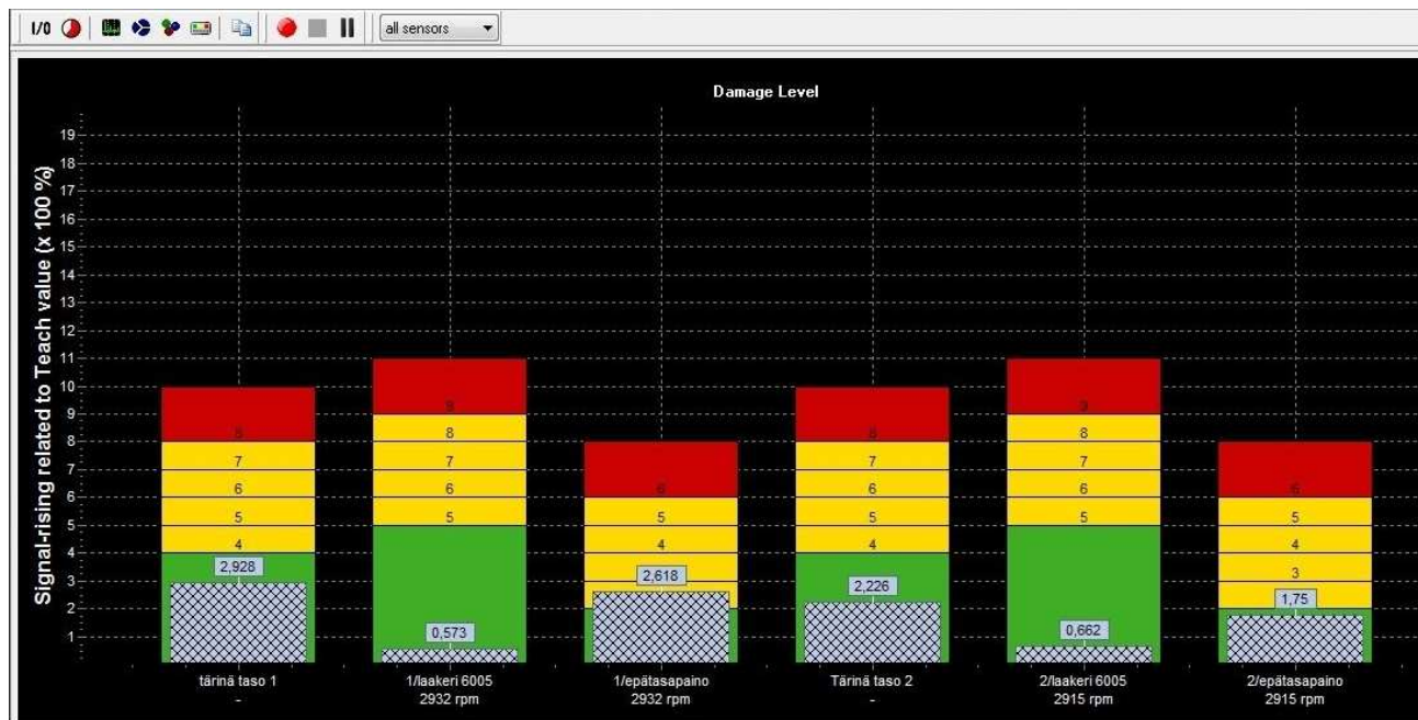
Kuva 26. Kuvasta nähdään kahden anturin mittaama kokonaistärinätaaso sekä laakerin tärinätaaso ja epätasapaino. Laakerin 1 akseli on epätasapainossa ja kuvaajasta näkee, että varoitusraja on ylitetty.
