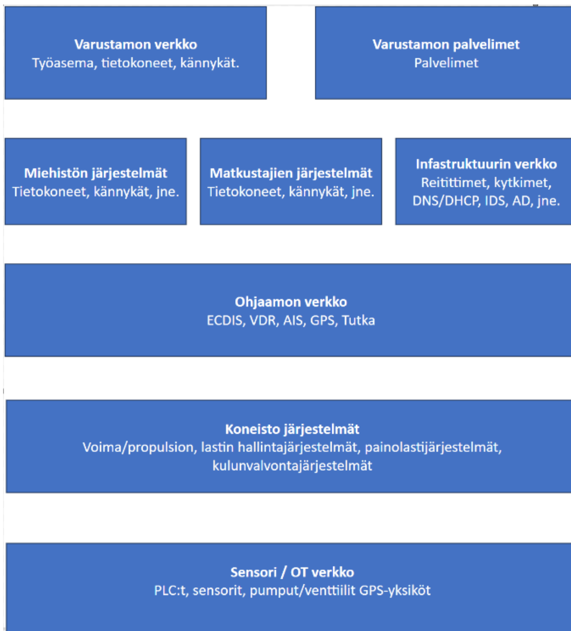
Kuva 2. Aluksen järjestelmien segmentointi esimerkki.
