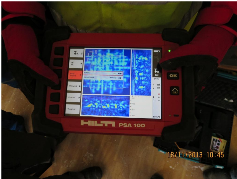
Kuva 7. Hiltin PSA 100. PS 1000:n tietojen käsittely-yksiökö
