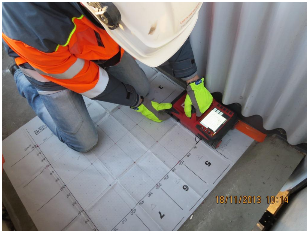
Kuva 6. Mittaustapahtuma Hiltin PS 1000:lla
