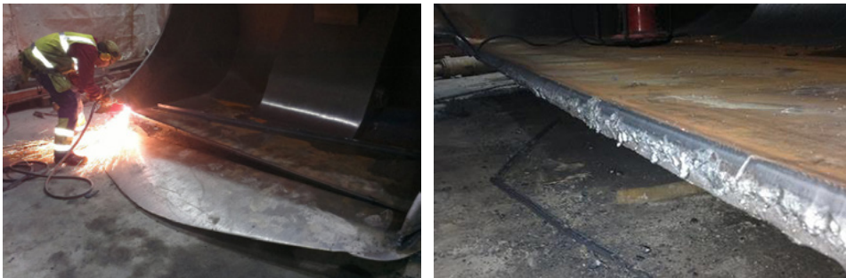
Kuva 12. Vanhan huulilevyn irrotus ja hitsausviiste.
