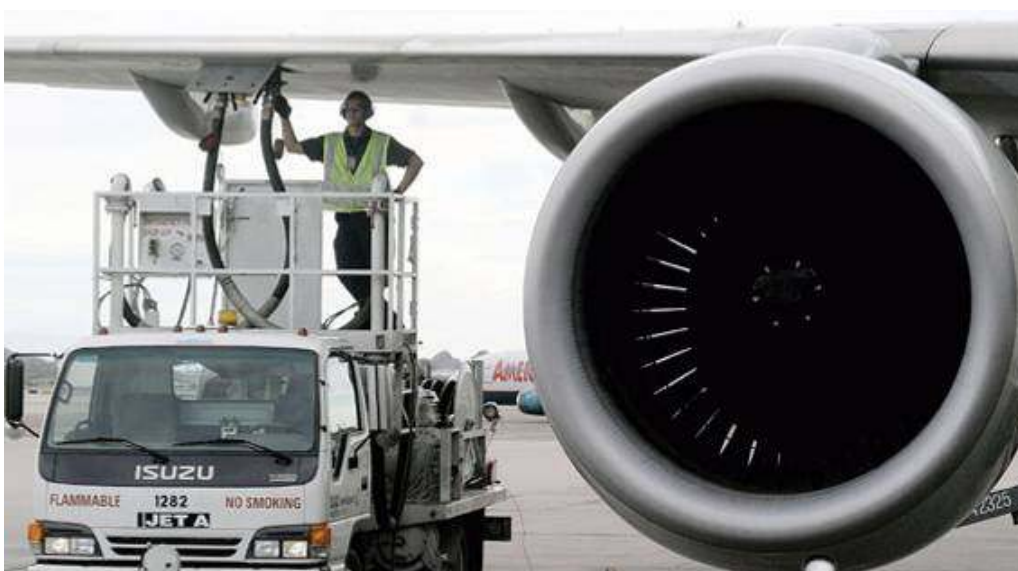
Kuva 13: Lentokoneen tankkaus pumppausautolla (Indian Aviation 2009)
