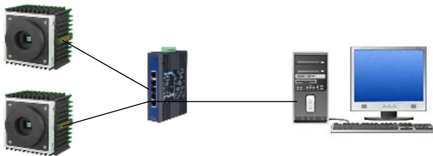
Kuva 26. Kytkentä, jolla testataan kaapelinpituuden vaikutusta nopeuteen.
