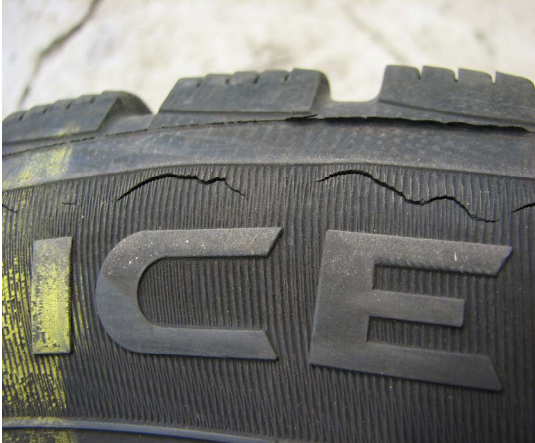
Kuva 19 Renkaan kyljessä olevia halkeamia
