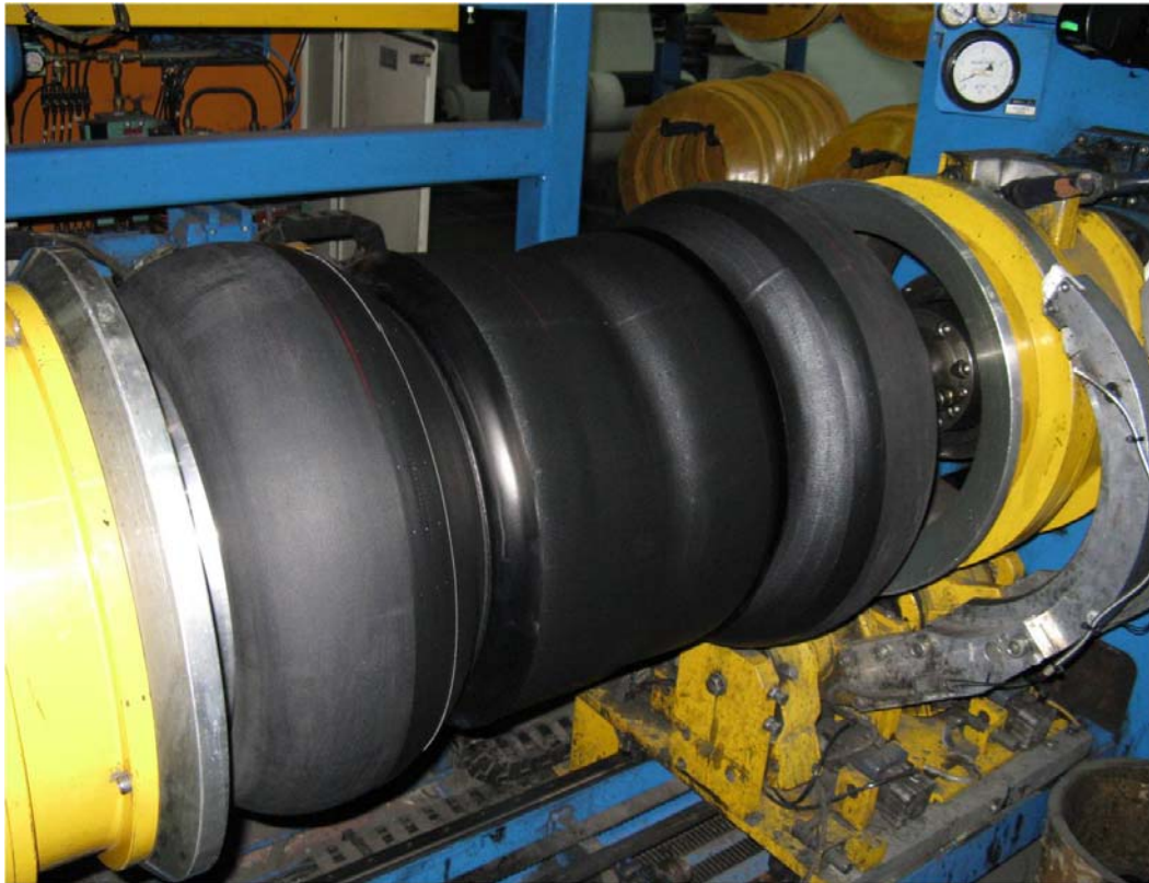
Kuva 2 Rengasaihio kokoonpanokoneen vyöruumulla paineistettuna
