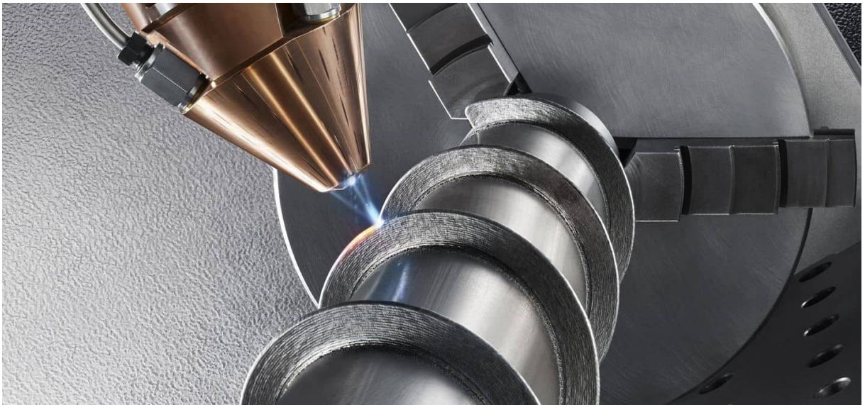
Kuva 7 Haastavia muotojen tekeminen DED-prosessissa (Engineering Product desing, 2019)
