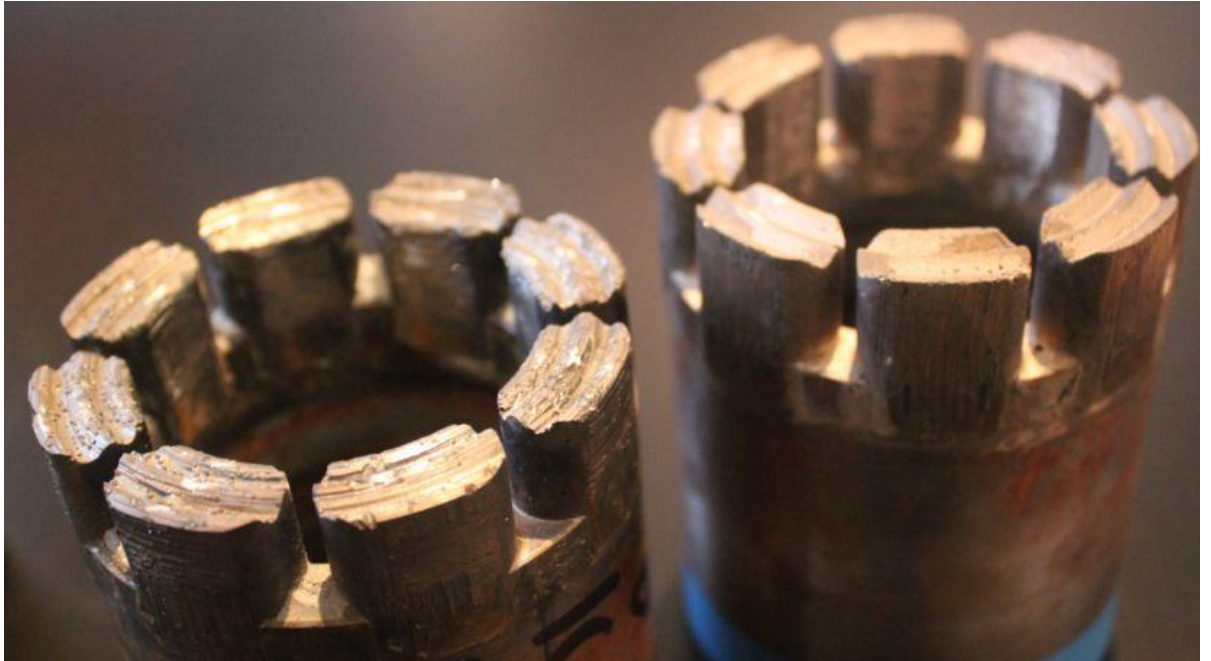
Kuva 17 Käytetty ja käyttämätön Wolf T - 3 terä
