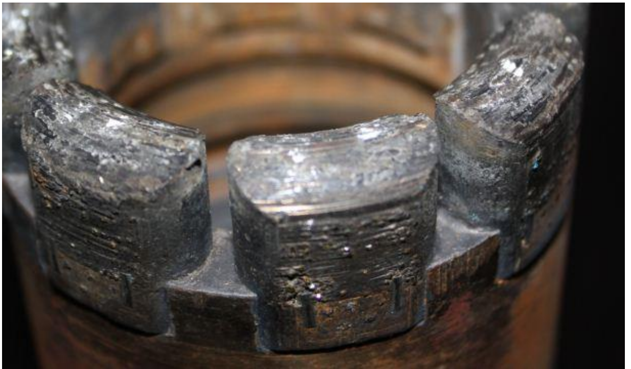
Kuva 18 Lähikuva Wolf T - 2 terästä käytön jälkeen
