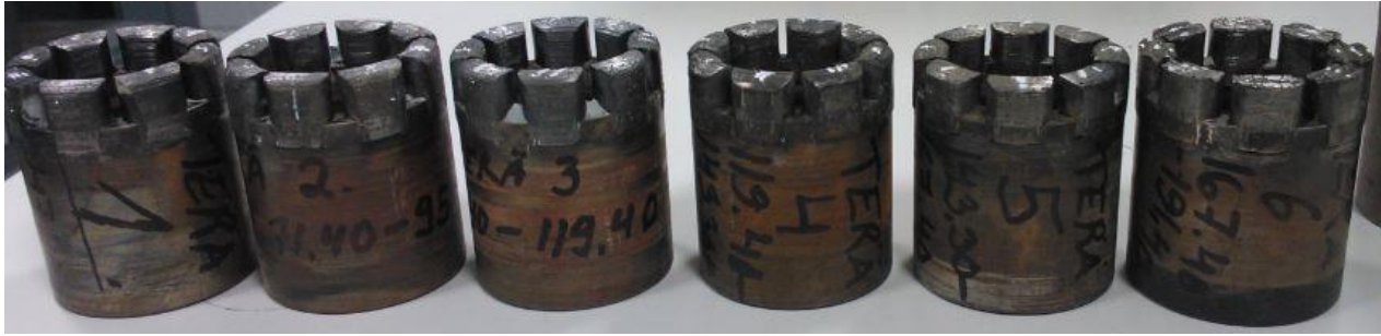
Kuva 14 Testattavat terät käytön jälkeen
