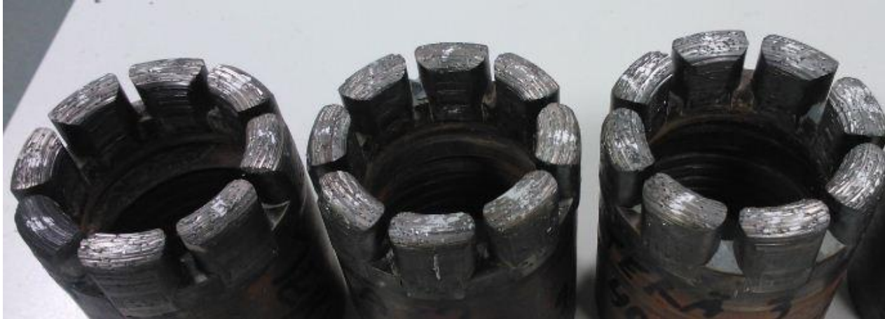
Kuva 15 Terien NWL2 M35, M5T ja M7T segmentit käytön jälkeen
