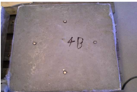
KUVA 8. Kutistumalaatta 4B, kutistumanastat asennettu
