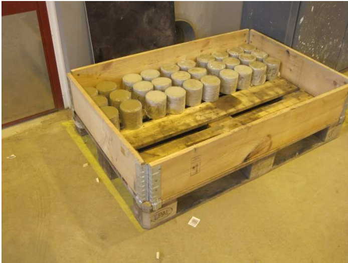
KUVA 4. Koekappaleet kelmutettuina odottamassa testausta
