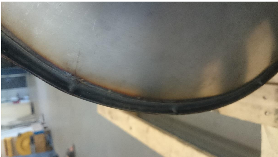
Kuva 33. Päädyn hitsi lähempää tarkasteltuna. (Salmi 2010-06-13)
