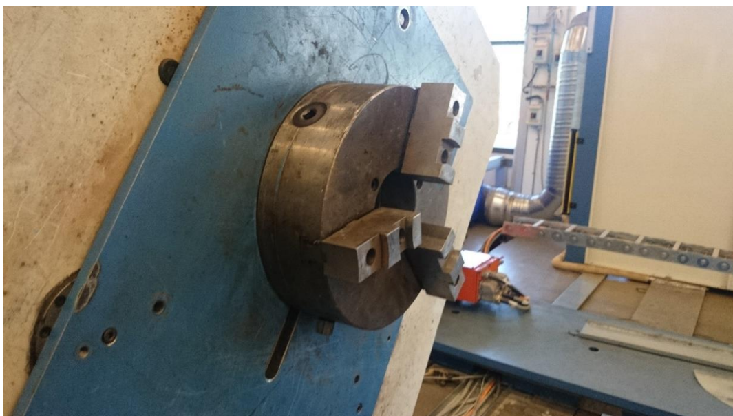
Kuva 21. Sorvipakka kiinnitettynä kääntöpöytään. (Salmi 2010-06-13)
