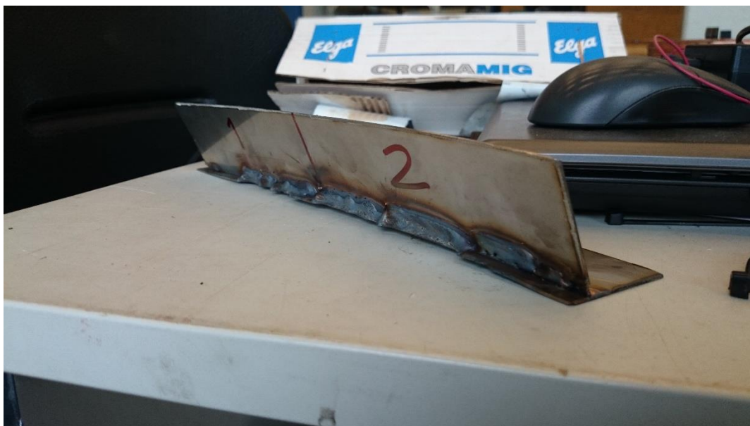
Kuva 18. Päädyn koekappaleeseen tehtyjä hitsejä. Kappaleessa on hitsattuna monta eri hitsiä. (Salmi 2010-06-13)
