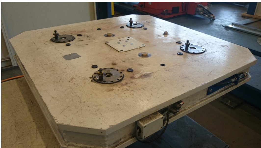
Kuva 20. Kääntöpöydän kiinnityspisteet. (Salmi 2010-06-13)
