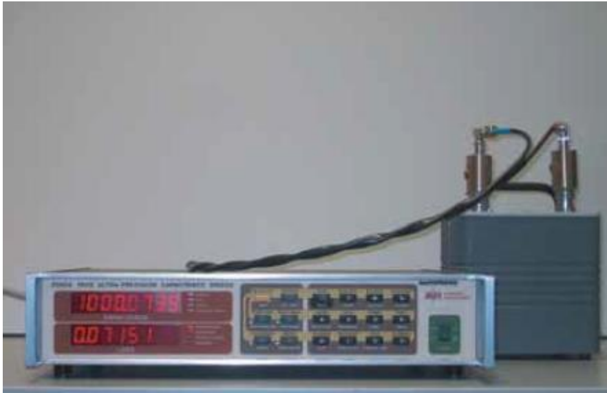
Kuva 9. AH2500A-mittasilta ja kalibroitava 1 nF kapasitanssinormaali [8]
