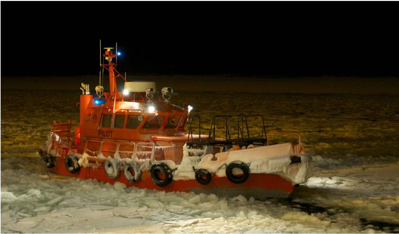
Kuva 66. Luotsikutterit on suunniteltu jäissäkulkuun ja talviolosuhteisiin. Kutteri murtaa noin 40 cm:ä paksua kiintojäätä. Lisäksi luotsiplatformissa ja kaiteissa kiertää lämmin vesi ja ohjaamossa on lämpölasit. (Olli Taipale 2014).
