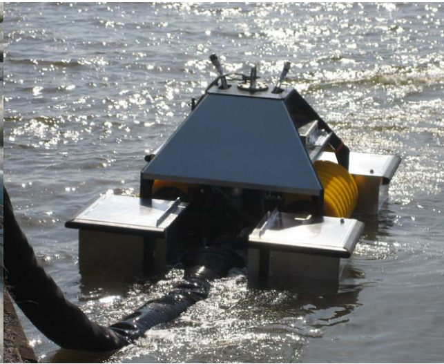
Kuva 50. Lamor Arctic skimmeri on operoitavissa joko nostopuomilla tai itsekelluvana (Juha Muhonen 2007 ja 2009).
