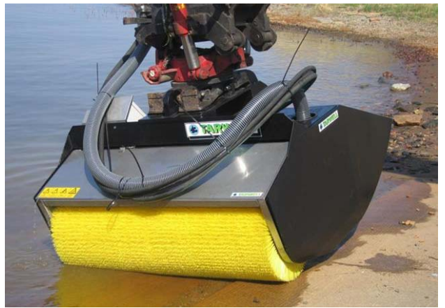
Kuva 48. Harjakauha. Kauhan kiinnitys tässä mallissa NPT-10 kaivinkoneeseen (Olli Kilpeläinen 2014).
