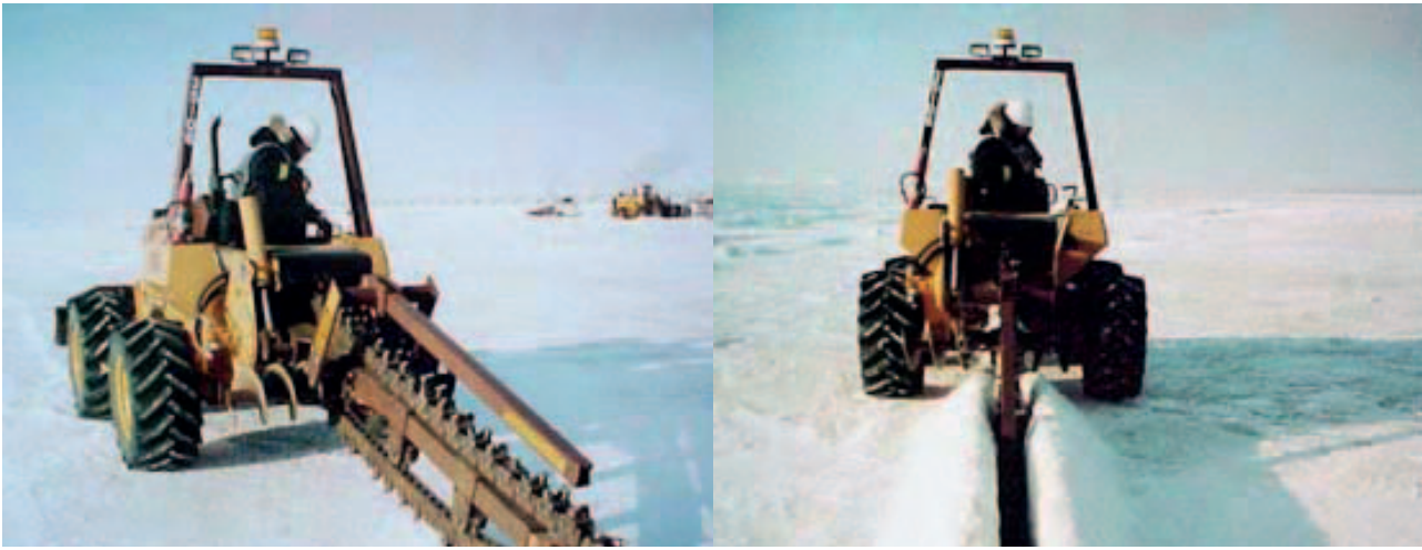
Kuva 37. Jään sahausta maakaapelointiin tarkoitetulla ketjukaivurilla eli ns. ditch witch'llä (Oil Spill Solutions 2013).
