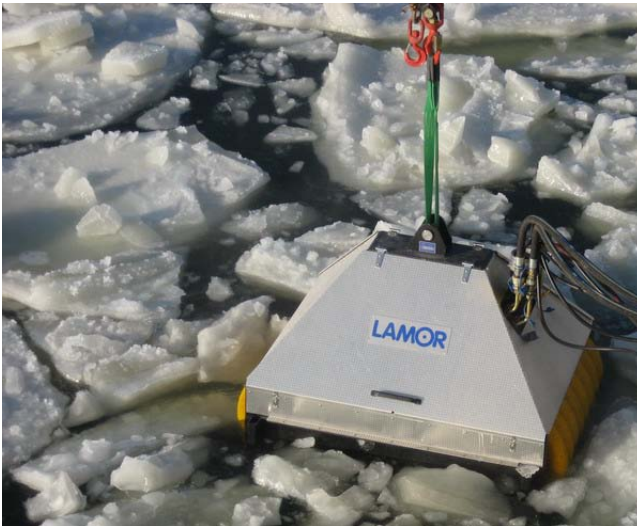
Kuva 50. Lamor Arctic skimmeri on operoitavissa joko nostopuomilla tai itsekelluvana (Juha Muhonen 2007 ja 2009).
