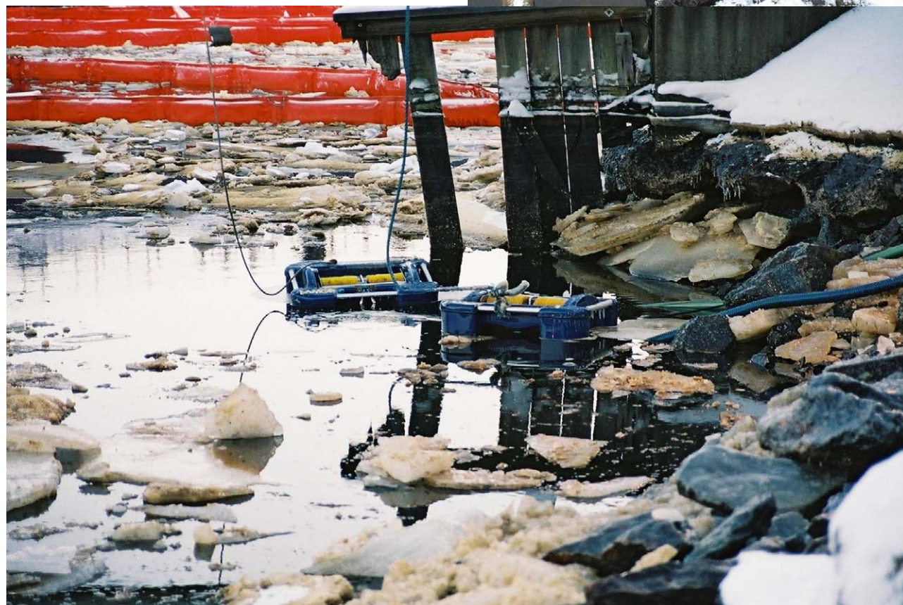
Kuva 52. Dieselin keräystä noin -20°C pakkasessa Minimax 12-skimmereillä (Juha Muhonen 2002).
