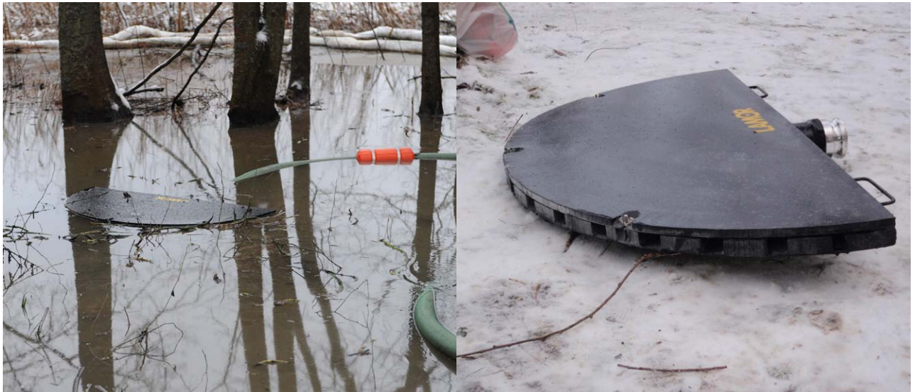
Kuva 54. Manta Ray -skimmerin avulla on mahdollista nostaa imuauton hyötysuhdetta (Juha Muhonen 2013 ja Jouko Pirttijärvi 2013).
