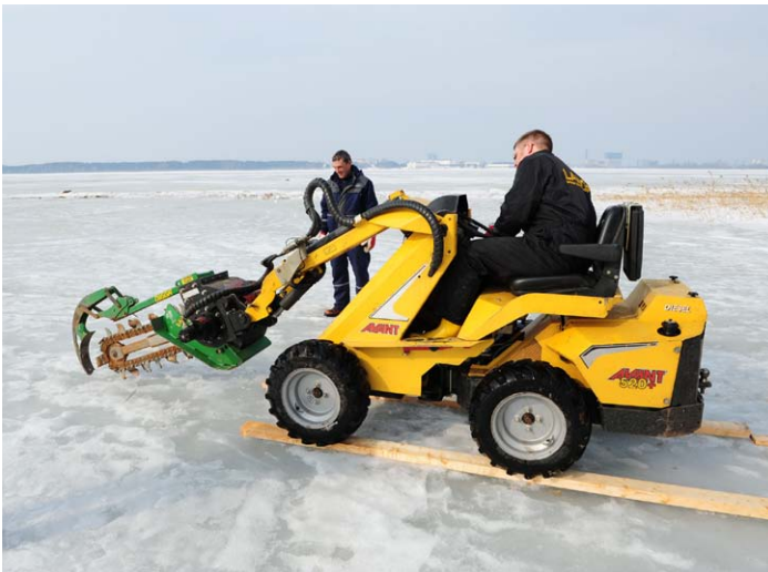
Kuva 38. Railotusta ketjukaivurilla Virossa (Juha Muhonen 2010).
