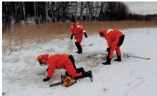
Kuva 30. Keräilyaltaiden sahausta moottorisahalla Raaseporissa (Jouko Pirttijärvi 2013) sekä sahattujen jäiden nostoa (DOWCAR 2014).
