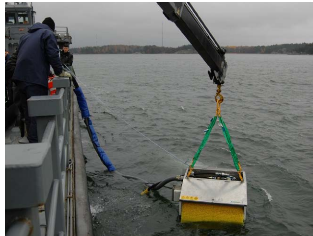
Kuva 51. Skimmeri, jota voidaan käyttää jääolosuhteissa nosturista riiputtaen tai ponttonin päällä kelluttaen. Kuvat Helsingin pelastuslaitoksen Sirkka-harjoituksesta (Melinda Pascale 2008).
