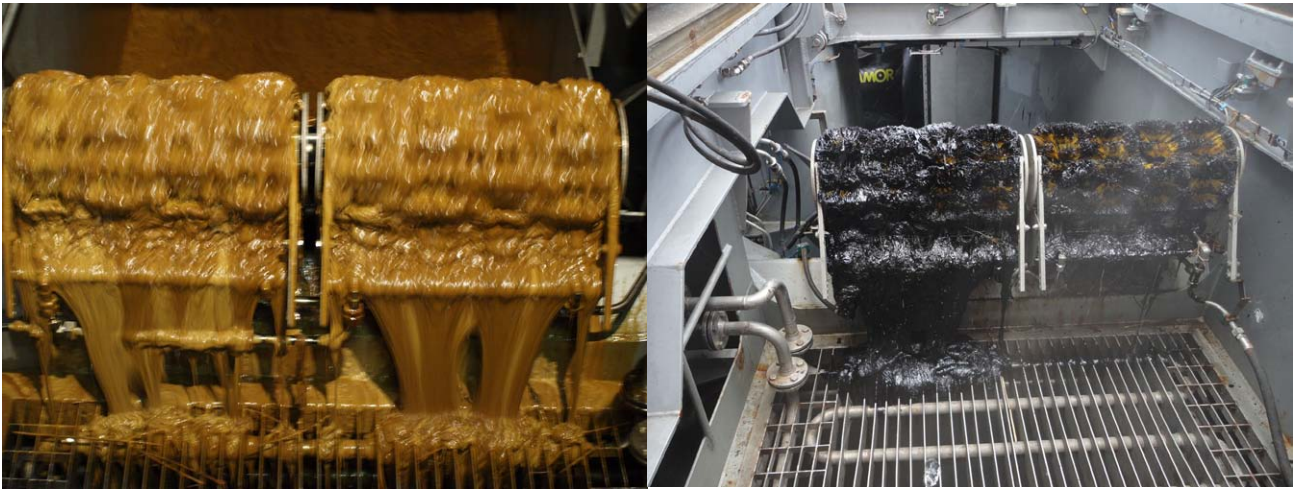
Kuva 49. Mäntyöljyä kerättiin Kaskisissa noin -1-0^{\circ}\text{C} lämpötilassa. Vasemman kuvan harjahihnassa ei ollut lämpökamppaa (Juha Muhonen 2011). Oikeanpuoleinen kuva on Norjan Hvalerista 2011, jossa raskasta polttoöljyä kerättiin jäiden joukosta -20^{\circ}\text{C} pakkasessa (Swedish Coast Guard 2011).
