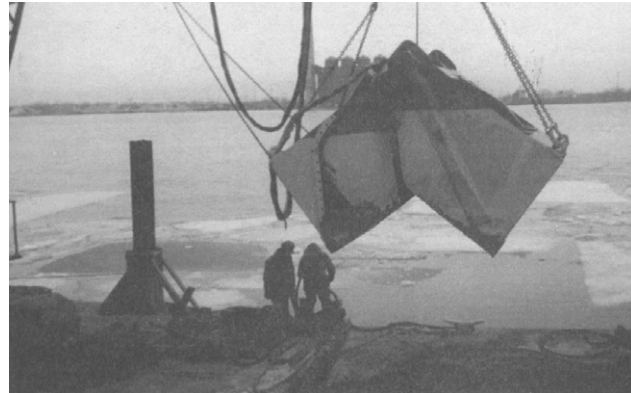
Kuva 60. Erittäin säästyneen öljyn keräämiseen käytetty ruoppauskauha (Helland et al. 1997, 5).
