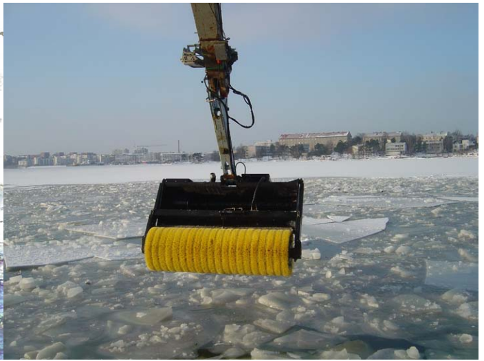
Kuva 46. Suomen ympäristökeskuksen harjakauha sekä Lamorin Oil Recovery Bucket (SYKE 2003 ja Juha Muhonen 2005).
