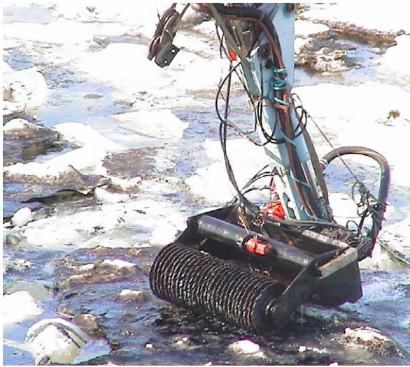
Kuva 46. Suomen ympäristökeskuksen harjakauha sekä Lamorin Oil Recovery Bucket (SYKE 2003 ja Juha Muhonen 2005).
