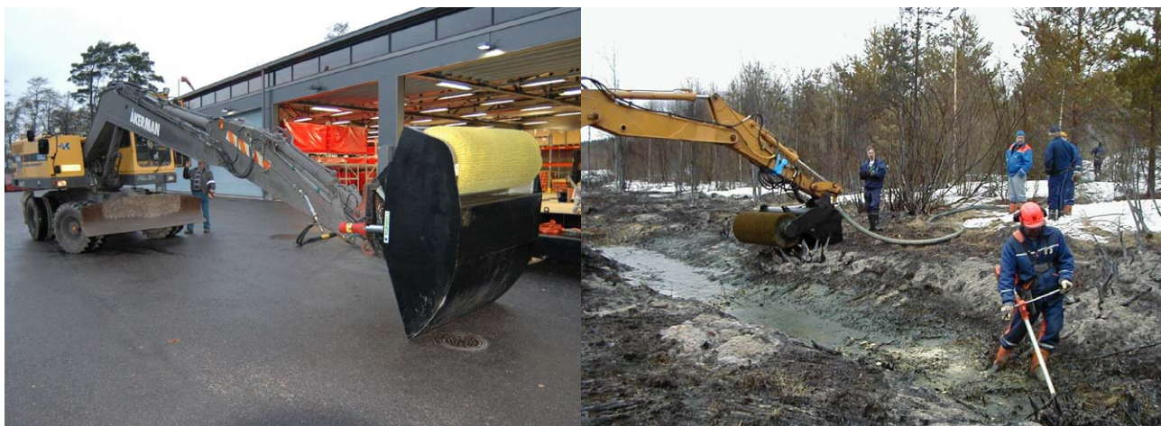
Kuva 64. Kaksiharjainen harjakauha (Melinda Pascale 2008) sekä SYKE:n harjakauha raakaöljyn keräyksessä Vainikkalassa (Uudenmaan ELY-keskus).
