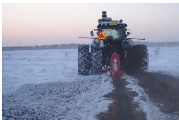
Kuva 39. Suon esiojituskairaa eli kopo-kairaa voidaan käyttää jään railottamiseen. Jäällä vetokone olisi hyvä olla kevyempi, jos vain konetehot riittävät (JPF Peat Oy 2014).
