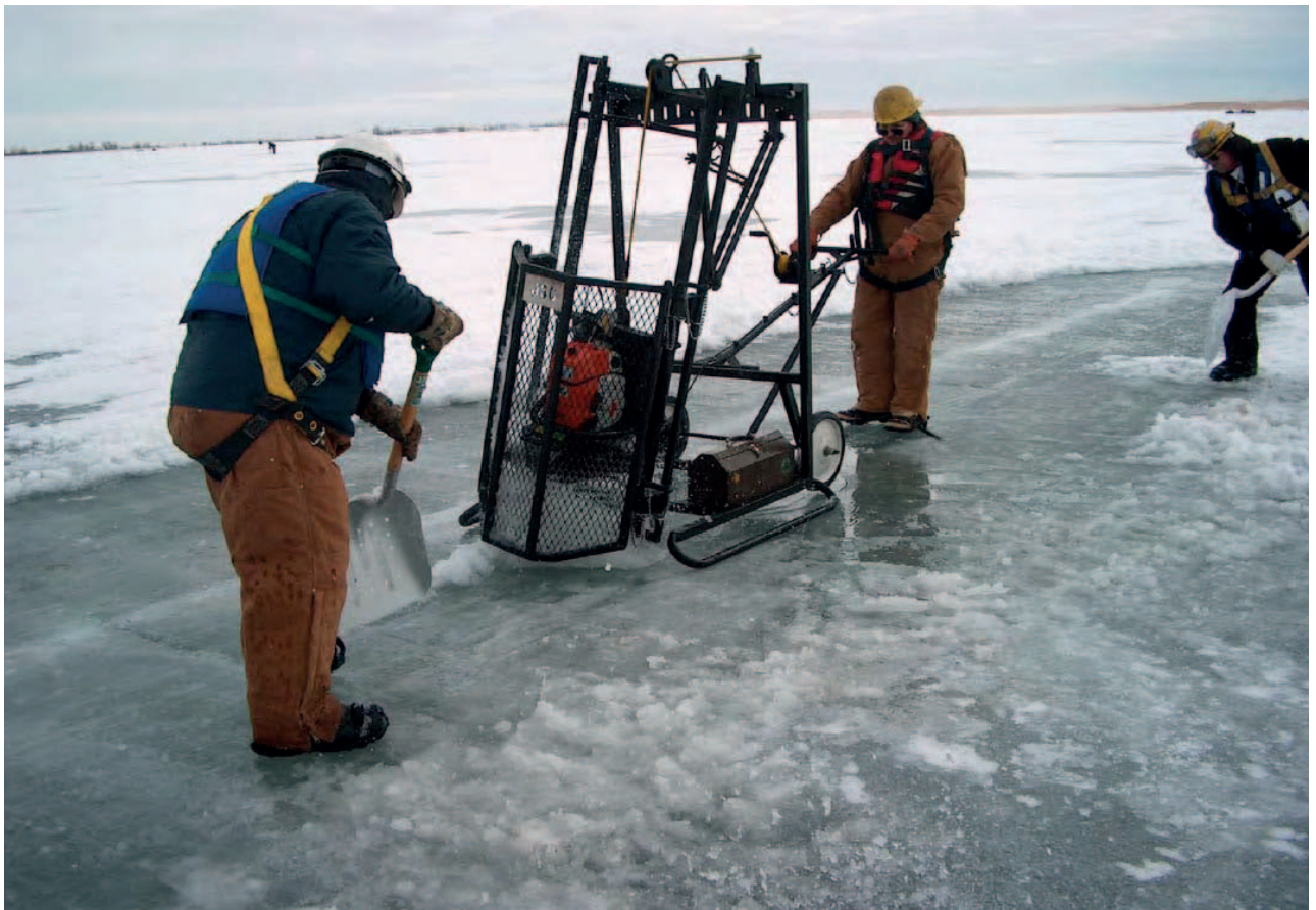
Kuva 35. Jäänsahaukseen tarkoitettu Janicke -jääsahan ohjain (DOWCAR 2014).
