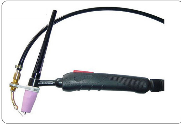
Kuva 4. Integroitu langansyötin käsivaraiseen hitsauspolttimeen. (Lincoln electric 2012, 61)
