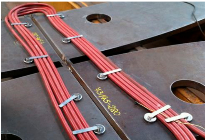
Kuva8: Hitsausrailojen esilämmitys ennen hitsausta. (directindustry.com, 2014)
