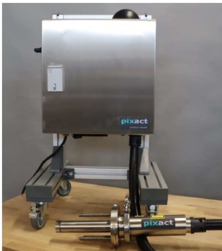
Kuva 5. Pixact kuplakuvauskamera ja tietokone (Pixact 2023)
