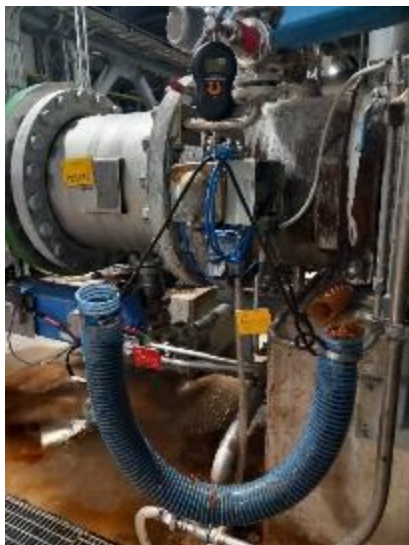
Kuva 55. Reaktori yhden syöttömassan kaasupitoisuuden mittaus tiheyden perusteella
