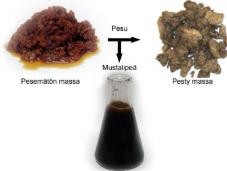
Kuva 1. Havainnekuva ruskean massan pesusta (Knowpulp 2023)
