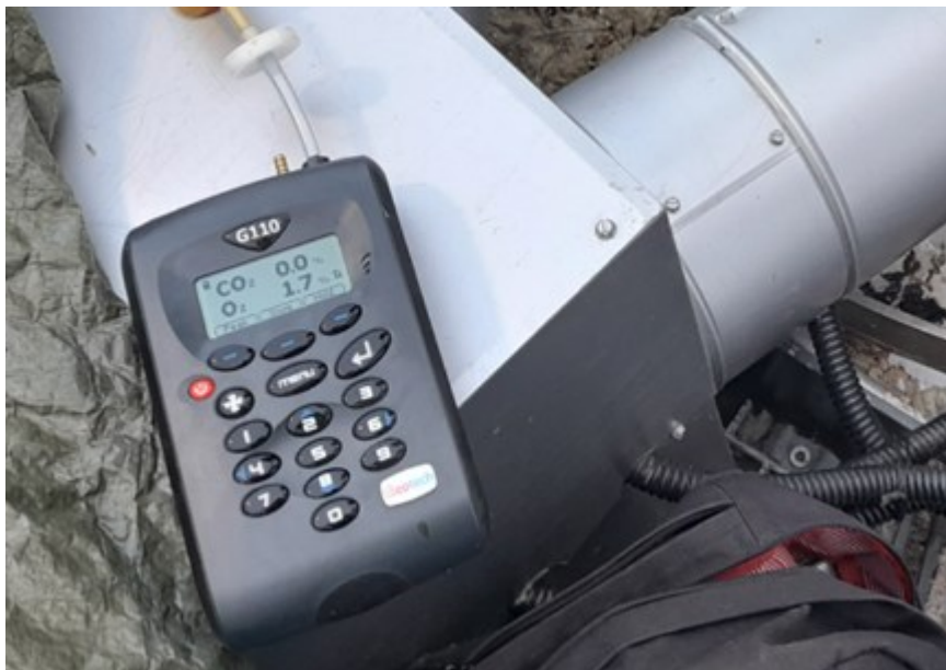
Kuva 19. Reaktori 1 yläpään jäännöskaasun happipitoisuuden mittaus
