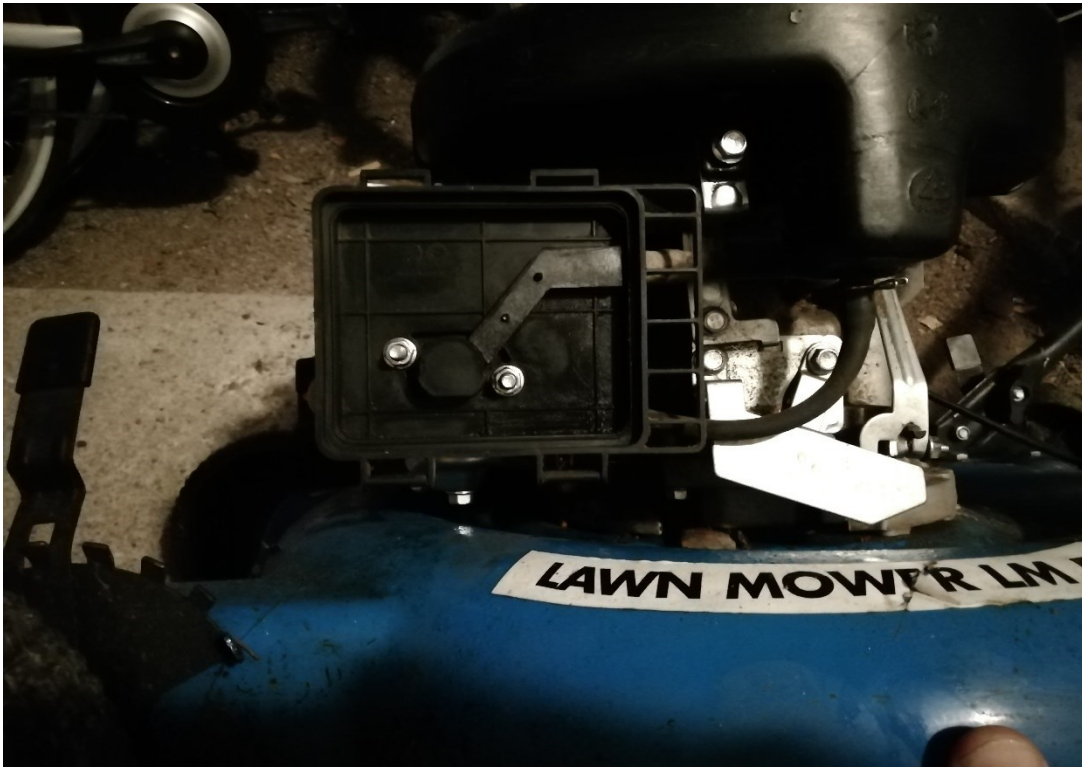
Kuva 5. Ilmansuodatin avattuna alkuperäisessä tilassaan.
