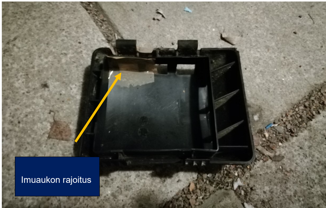
Kuva 6. Ilmansuodattimen kansi imuaukot rajoitettuna.
