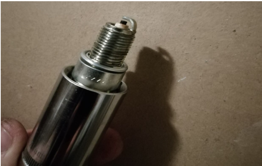
Kuva 10. Sytytystulppa irrotettuna tarkastusta varten.
