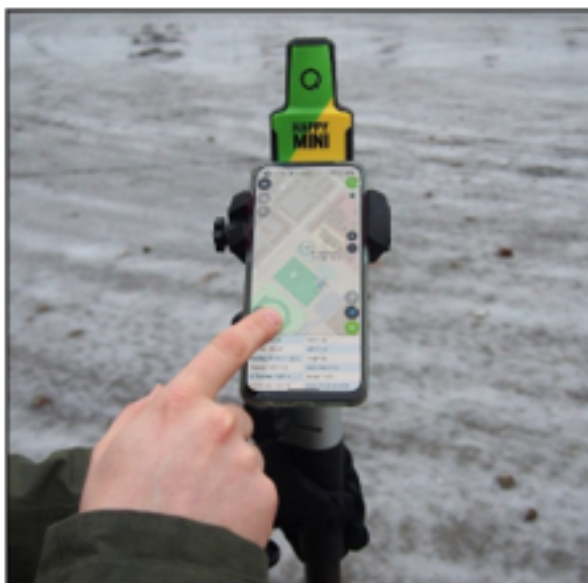
Kuva 3. Esimerkki ulkoisesta GNSS-laitteesta (Rekilä, 2024)
