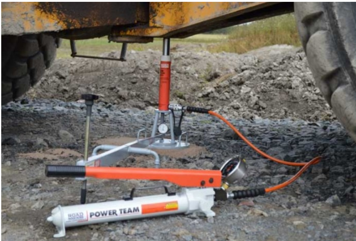
Kuva 8. Nykyaikainen levykuormituslaite, jossa on 1 mittauskello. (25)
