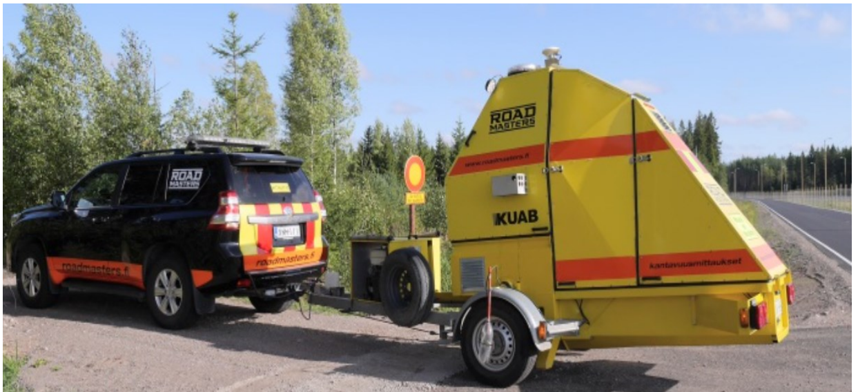
Kuva 6. Raskaan pudotuspainolaitteen perävaunu malli. (23)
