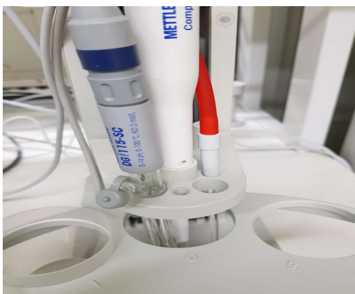
KUVA 4. Sekoitin, byretin poistoputki ja pH-sensori titrausastiassa käyttövalmiudessa.
