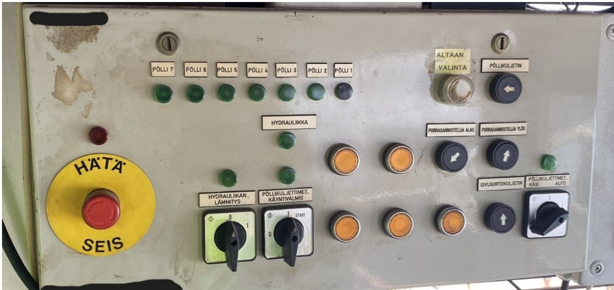
KUVIO 6. Pöllikuljettimen ohjauspulpetti.
