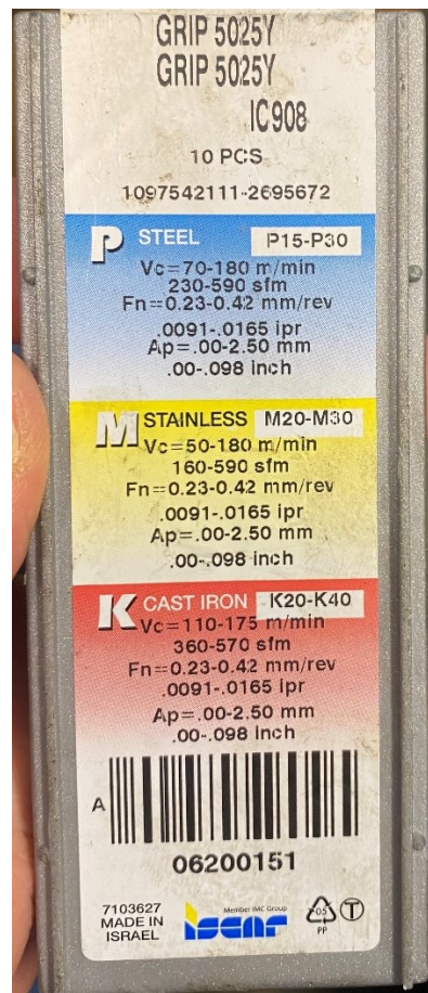
Kuva 4. Terävalmistajan suositukset työstöarvoille (Lehikoinen, 2024)
