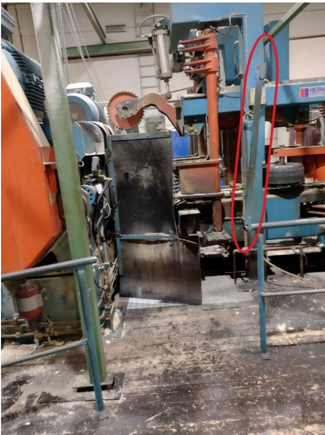
Kuva 12. Pelkkahakkurin korjaavat toimenpiteet (Salo, 19.12.2023)
