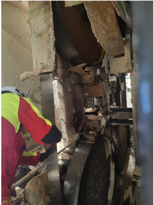
Kuva 27. Vannesahan terän vaihto
