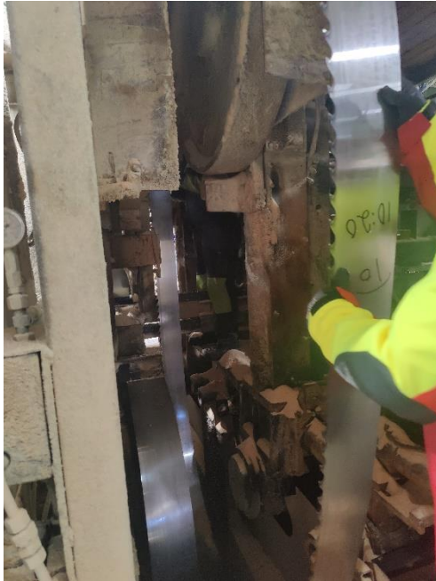
Kuva 26. Vannesahan terän vaihto
