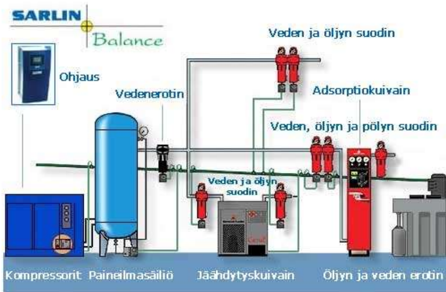
KUVA 3. Kompressorit ja jälkikäsittelylaitteet (Edu.fi 2023)
