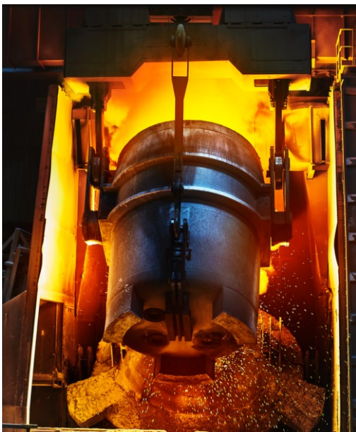
KUVA 3. Sulapanoksen kaato AOD-konvertertiin (Outokumpu Stainless Oy)
