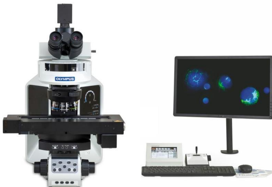
Kuva 2. Vasemmanpuoleisena fluoresenssimikroskooppi, johon on liitetty kamera ja kahdeksanpaikkainen skannaustaso. Oikealla näyttöpäite, mikroskoopin käyttö- ja ohjauspaneelit sekä tietokoneen näppäimistö. (Bioview.com, muokattu)
