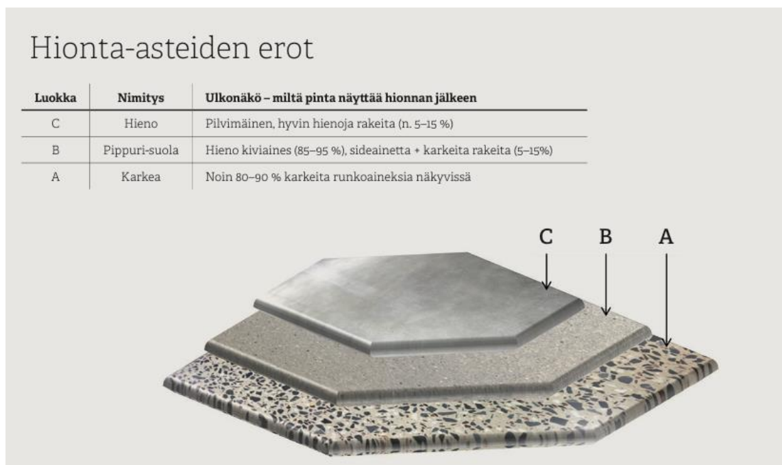
KUVA 6. Betonilattioiden hionta-asteiden erot (Mantsinen, 2020).
