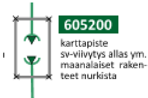
KUVA 20. Oulun Veden käyttämä koodi maanalaisille hulevesirakenteille
