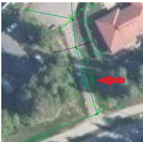
KUVA 21. Viivytysallas merkattuna Oulun Veden ylläpitämään NIS-järjestelmään
