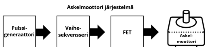
Kuva 3. Avoin askelmoottorijärjestelmä (mukailtu Orientalmotor 2023a)
