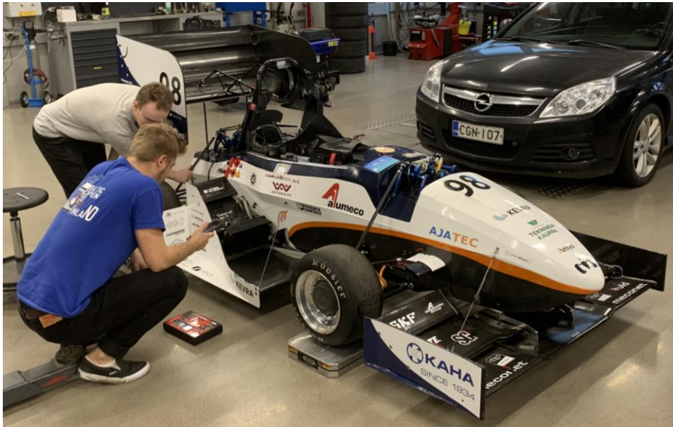
Kuva 3. HPF024-sähköformulan painomittaus nelipistevaalla.
