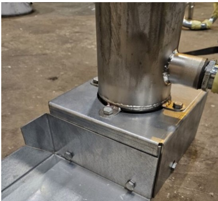
Kuva 15. Ilmeansäiliön ja telineen osa 2 kiinnitys.
