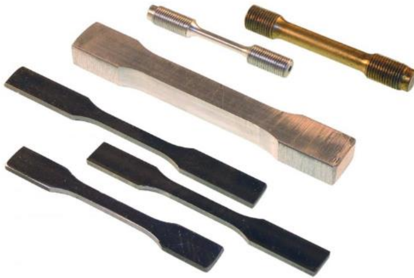
Kuva 3 Vetokokeen koekappaleita (DeWalt 2021.)
