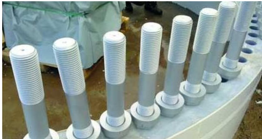
Kuva 12. Lavan kiinnityspultit (How is wind blade bolted to wind wheel hub).
