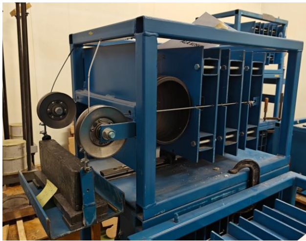
Kuva 8. Creep-test putkelle kuuden kuukauden testissä.
