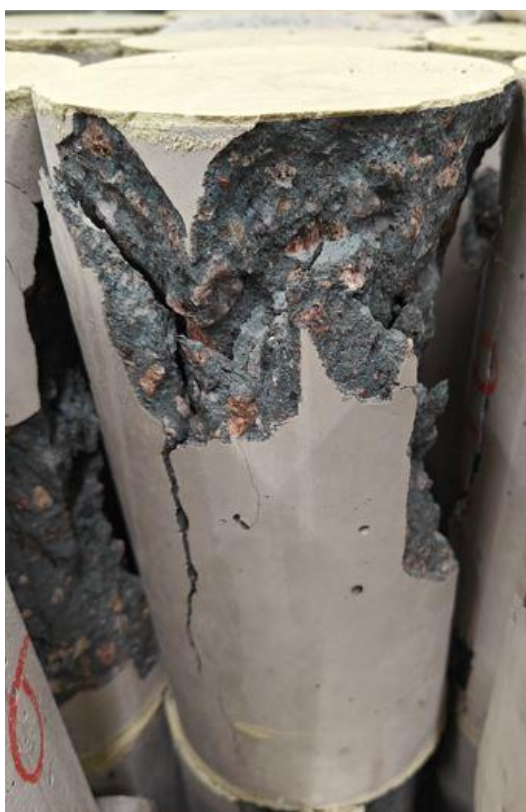
Kuva 5. Betonin puristustestin tulos.
