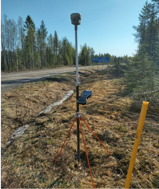
Kuvio 1 (vas.). GNSS-vastaanottimen kartoitussauva statiivilla tuettuna
