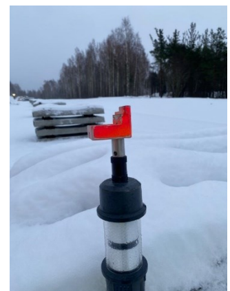
Kuvio 4 (kesk.). Magneetilla ja tasaimella varustettu kiskorauta (Kinnunen 2024)
