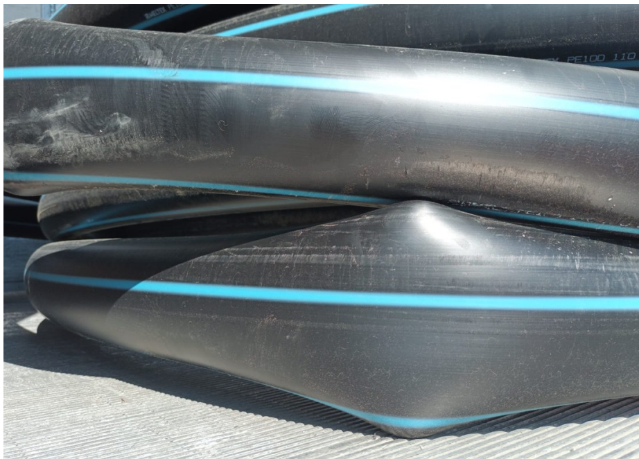
KUVA 3. Kuljetuksessa vaurioitunut 110 mm vesijohto (Turunen 2023, CC BY-SA)
