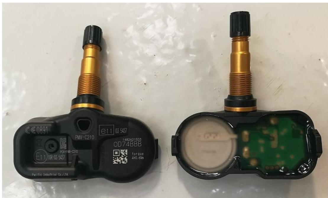
Kuva 31. Toyotan langaton rengaspainemittari (Clifford 2022)
