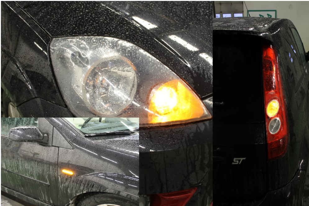
Kuva 16. Suuntavalaisimet edessä, sivulla ja takana.
