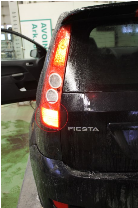
Kuva 13. Takavalon ja takasumunvalo (ympyröity)
