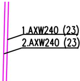
Kuva 1. Esimerkki keskijännitteen kj-runkokaapelin johtotunnuksista.
