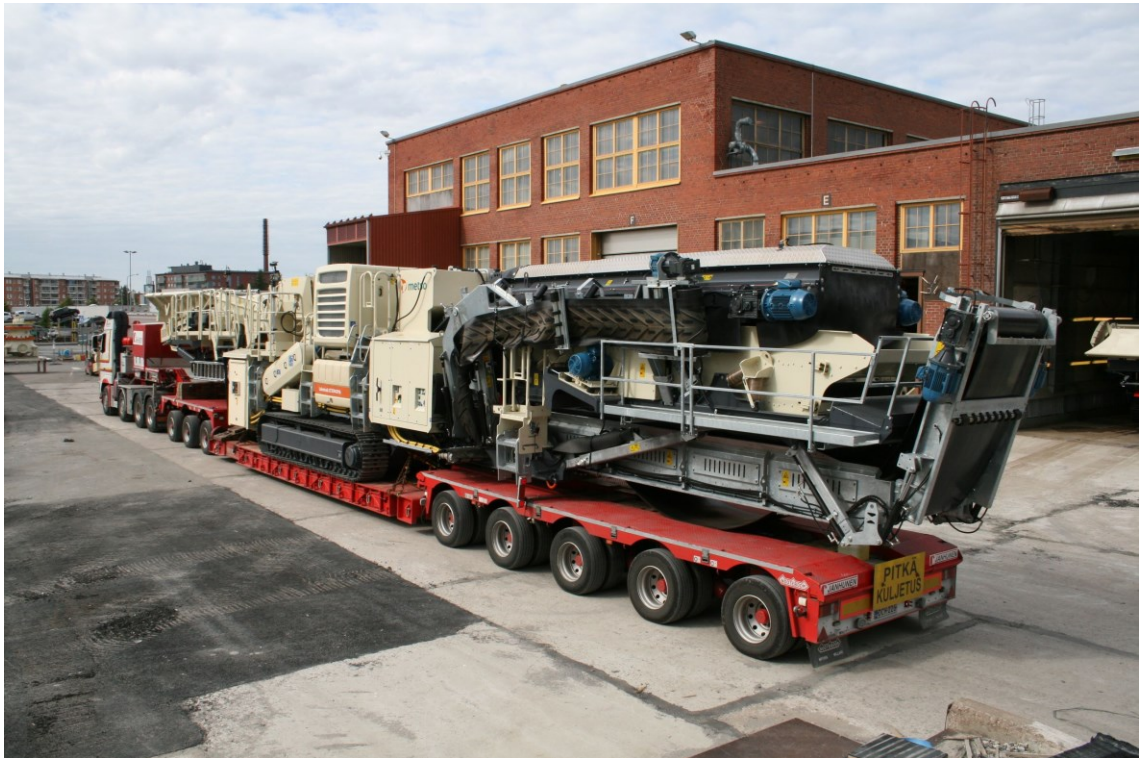
KUVA 2. Metso LT330D kuljetusasennossa kuljetuslavetin päällä. (Janhunen Oy n.d.)
