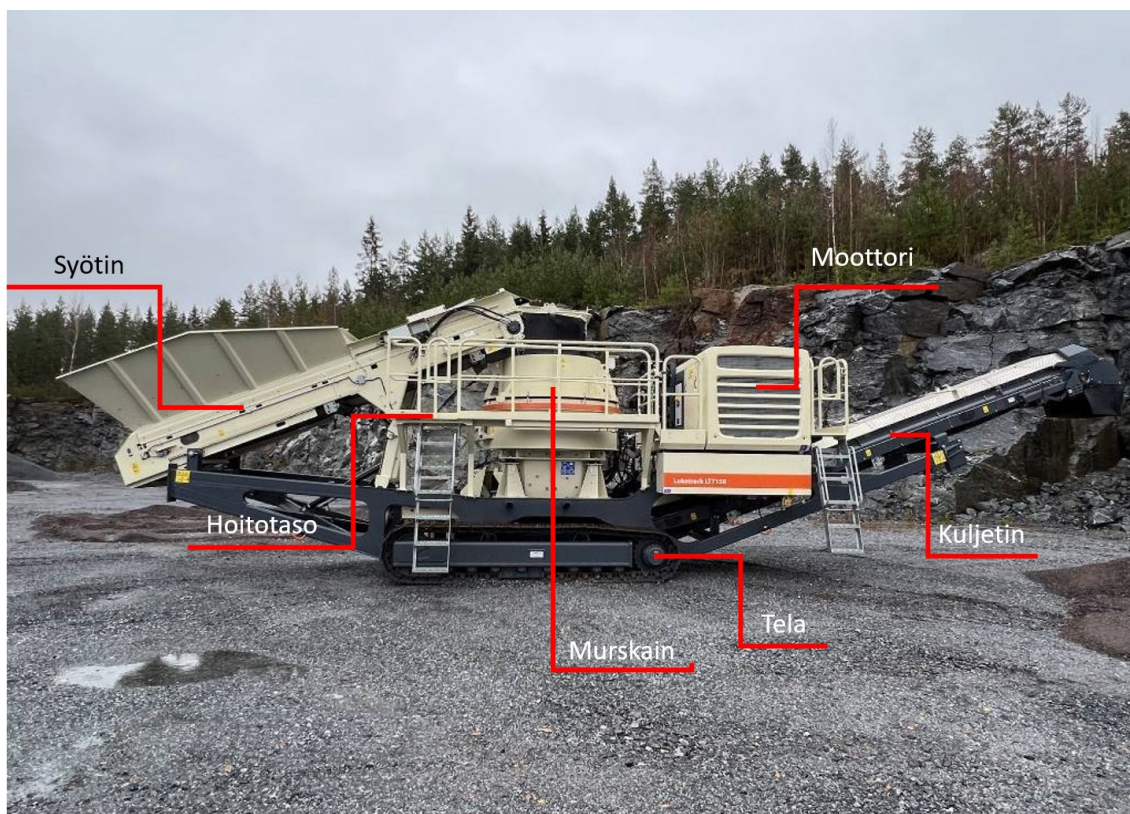
KUVA 3. Lokotrack murskaimen pääkomponentit. (Metso Oy, n.d.a, muokattu)
