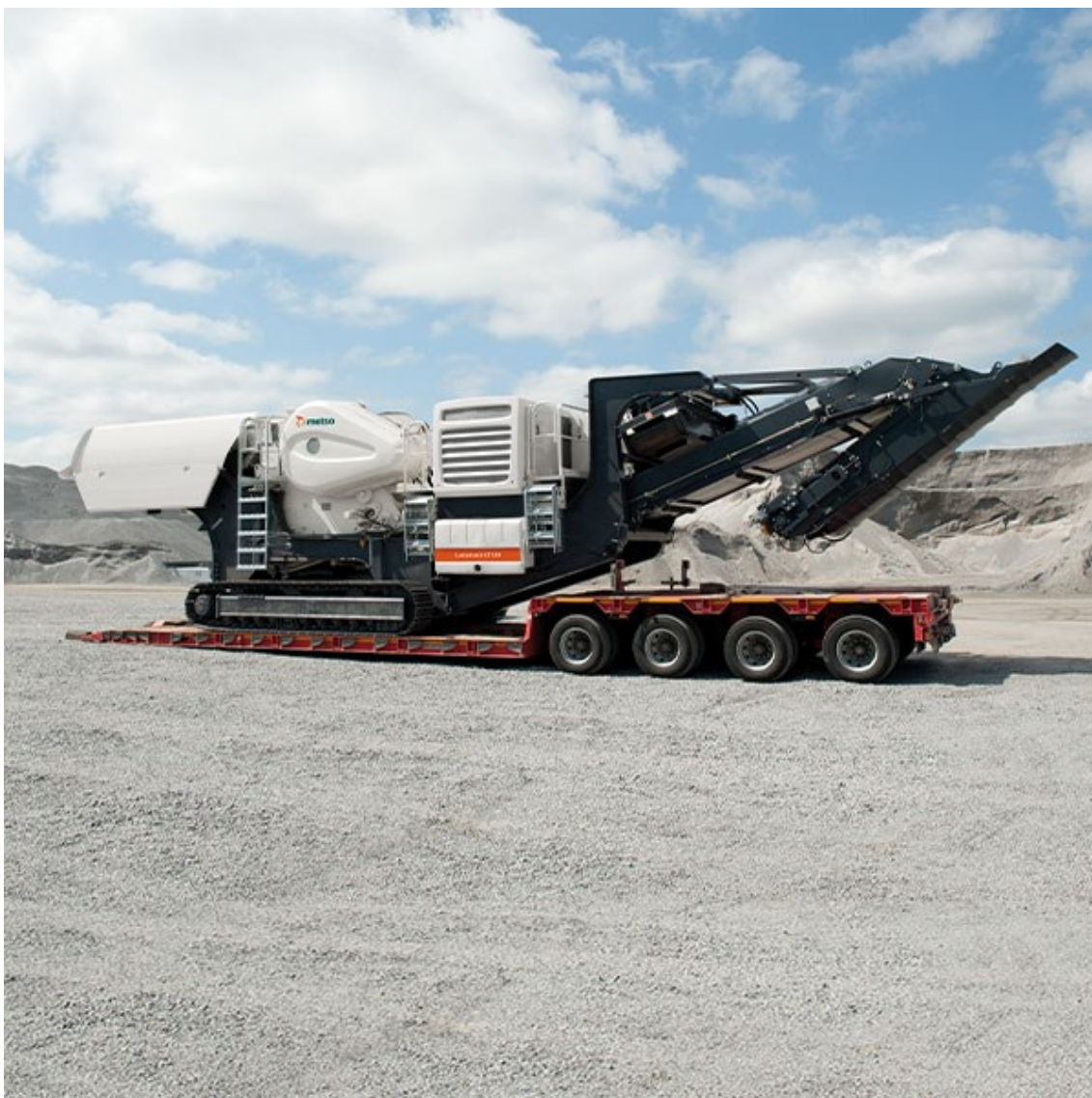
KUVA 4. Tela-alustainen murskain LT120 kuljetusasennossa. (Metso Oy n.d.b)
