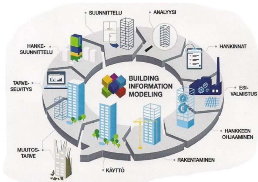
Kuvio 1 Tietomallintamisen elinkaari. (Sweco PM Oy, SWECO@BIM, 2017.)
