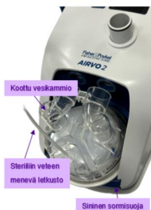
Fisher & Paykel healthcare Airvo™ 2. Sininen sormisuoja, koottu vesikammio ja steriiliin veteen menevä letkusto. (Kuva: Katja Pietilä)
