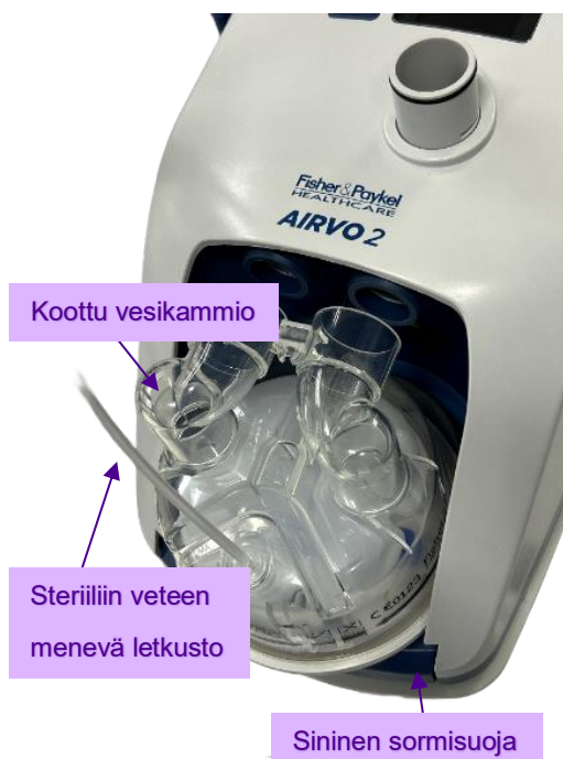
KUVA 1. Fisher & Paykel healthcare Airvo™ 2. Sininen sormisuoja, koottu vesikammio ja steriiliin veteen menevä letkusto. (Kuva: Katja Pietilä)
