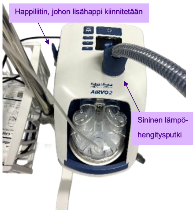
KUVA 3. Fisher & Paykel healthcare Airvo™ 2. Lisähapen kiinnitys happiliittimeen ja sininen lämpöhengityspotki. (Kuva: Katja Pietilä)
