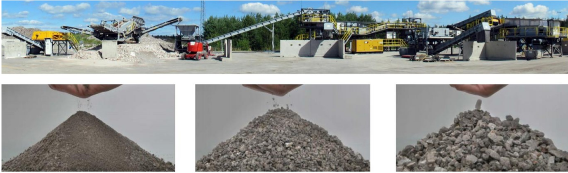
KUVA 23. Kuvan yläosassa jätteenpolton pohjakuonan käsittelylaitos ja alaosassa erilaiset lajitteet (Ramboll 2020)
