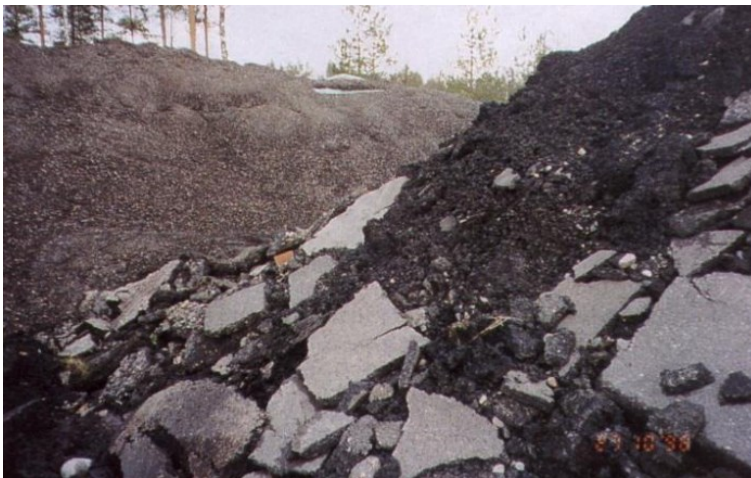
KUVA 19. Kuvan etuosassa ja oikealla purettua asfalttia rouheena ja paloina. (Mäkelä & Höynälä, 38)
