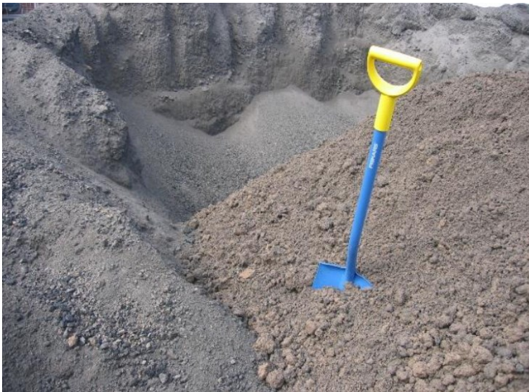
KUVA 18. Kivihiilen polton leijupetihiekkaa. Oikealla puolella oleva leijupetihiekka on tuoreempaa ja eri sävyistä vasemmanpuoleiseen vanhempaan leijupetihiekkaan verrattuna. (Ramboll 2020)
