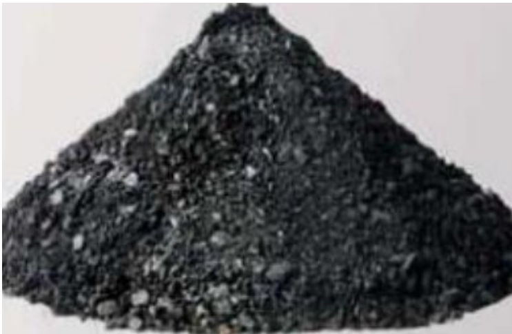
KUVA 2. Ferrokromikuonahiekkan ulkonäkö (Väylävirasto 20/2022, 54)
