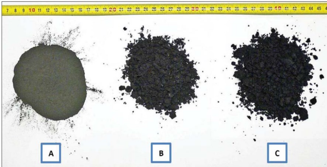
KUVA 16. Lentotuhkan ulkomuoto, kun vesipitoisuus on A = < 1 %, B = 26 % ja C = 41 % (Infra 062-710191, 5.)
