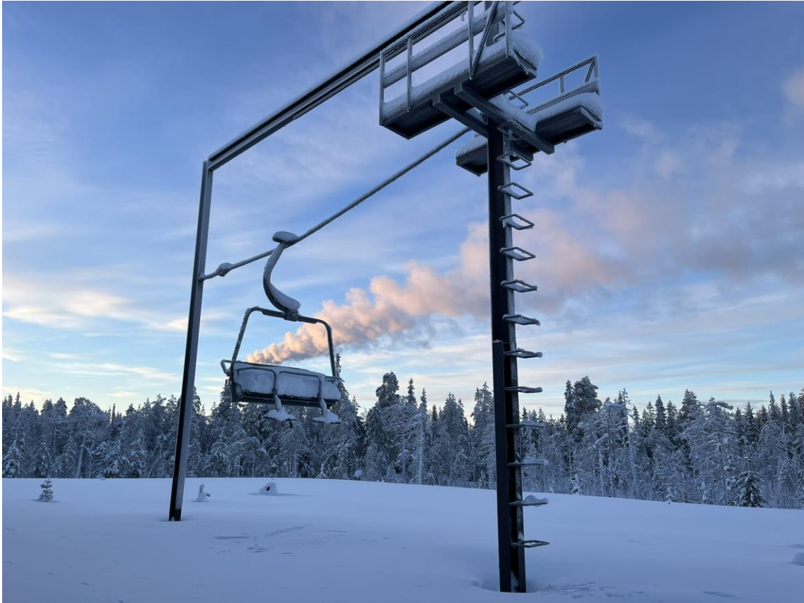
Kuva 2. Rukan paloasemalla sijaitseva hissipelastussimulaattori
