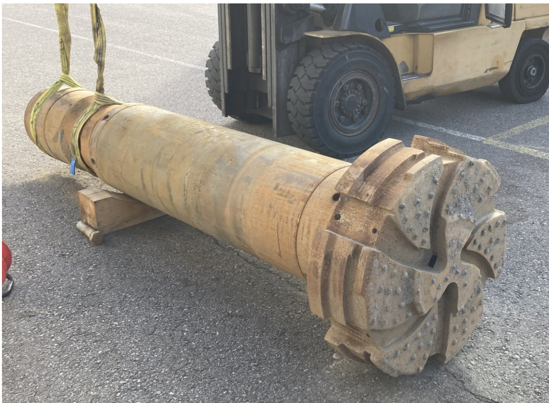
KUVA 3. Mincon iskunvaimennin, upposasara ja porausjärjestelmän pilotti (Simo Elovirta).
