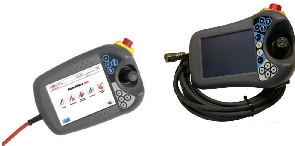
KUVA 4. IRC5 ohjelmointipaneeli. Alkuperäinen 2004 ja päivitetty 2008 (ABB)
