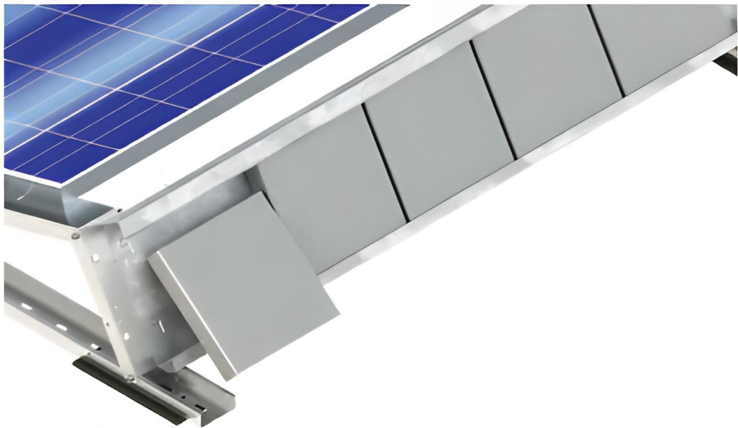
Kuvio 37 Orima-Tuotteen SMART- ja ALFA-järjestelmiin sopivat tuulensuojalevyinä ja painoina toimivat "helposti saatavilla olevilla vakiokoon pihalaatat" jotka ladotaan järjestelmän painopidikkeisiin (Orima-Tuote Oy, n.d)
