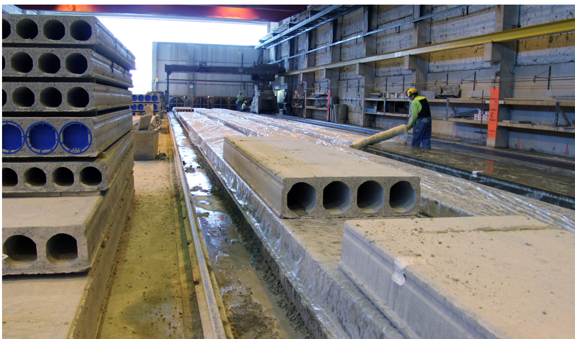
Kuva 4. Rakennuslehden kuva ontelolaatan valmistuksesta tehtaalla (Kortelainen, 2019)
