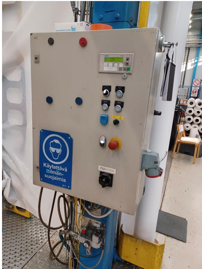
Kuva 15. Ohjauslogiikka pussitussolun porttiin (Virtanen 2024).
