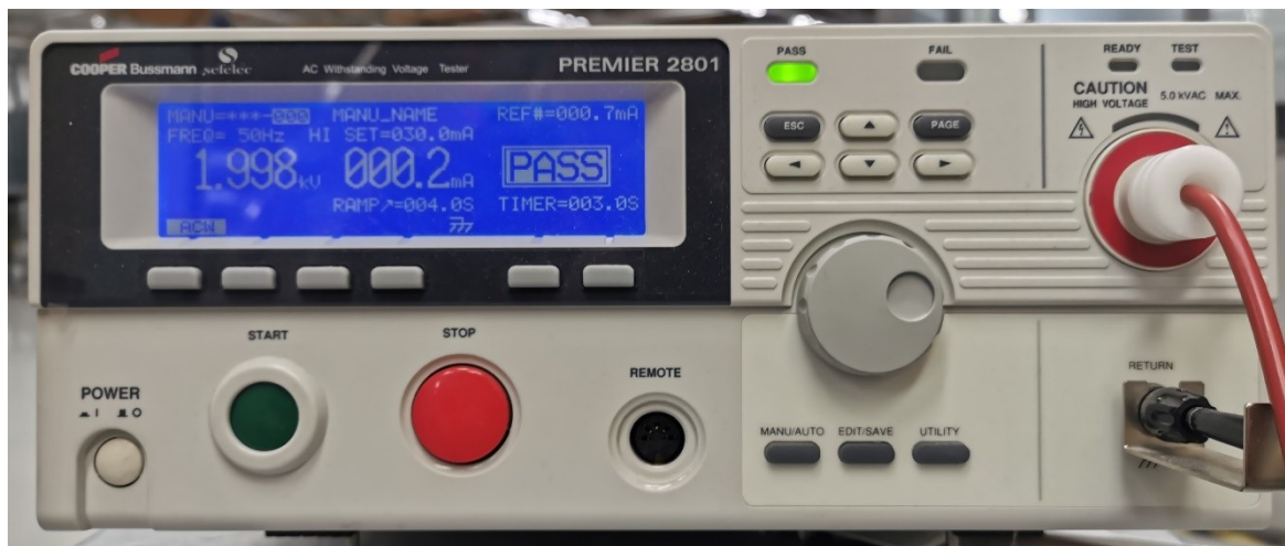
KUVA 4. 2 kV:lla suoritettu jännitekoe (Rönkkö, 2023)
