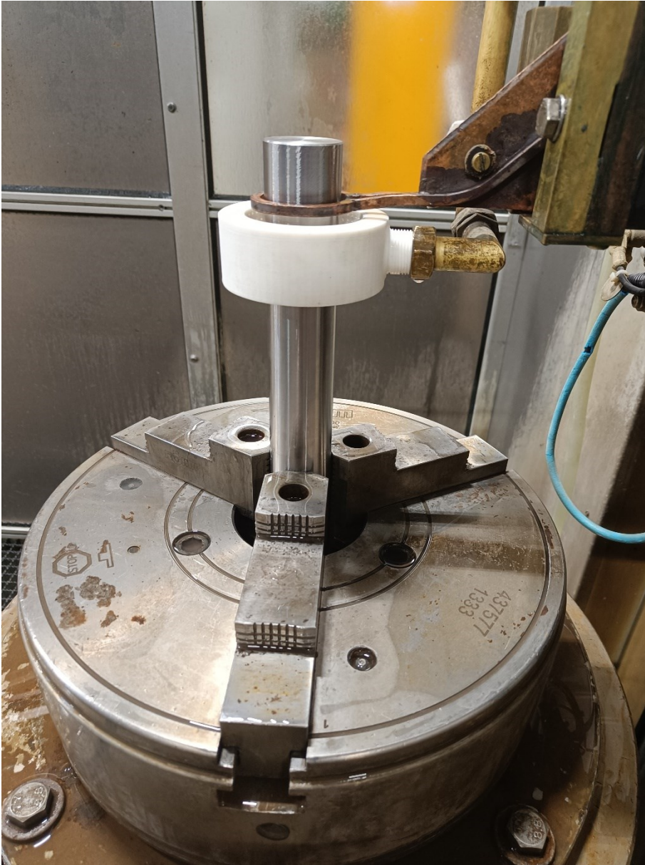
Kuva 5. Karkaisukokeessa tarvittavat toimilaitteet.
