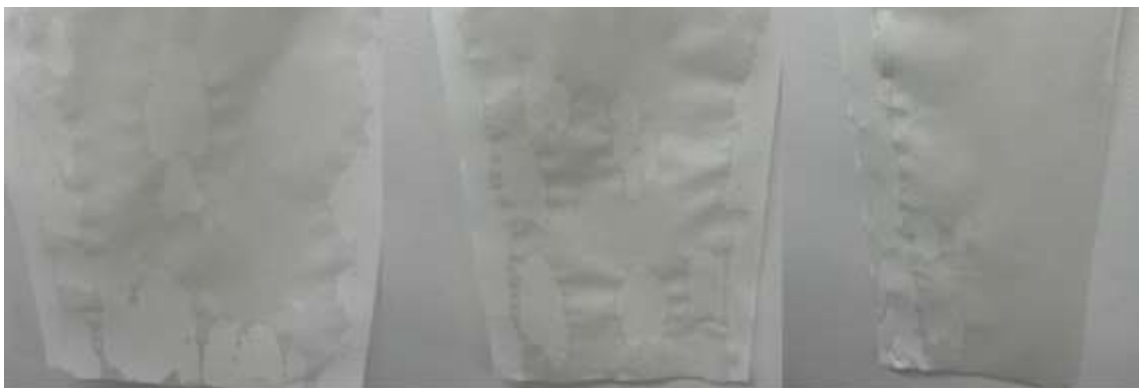
KUVA 6. Kastelujäljet vasemmalta oikealle: telarako 20&45, telarako 25&50 ja telarako 19&45
