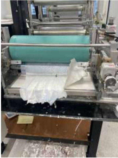
KUVA 5. Katkennut rata päällystysyksiköllä
